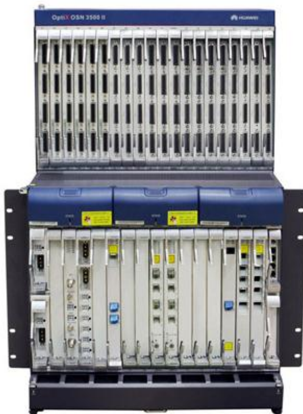
Сурет 3.2 – OptiX OSN 3500 құрылғысының кескіні
